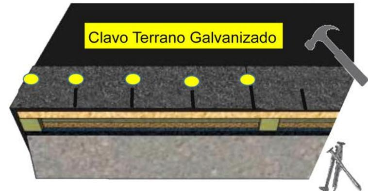
2. La primera fila de la teja debe ser instalada sobre la primera corrida. Cada palmeta deberá ser instalada con 5 clavos a 2.5 cm sobre el corte de las pestañas. De ser instaladas en zonas de vientos fuertes o techo con mucha inclinación (mayor a 45°), se recomienda instalar tres clavos adicionales según imagen.
